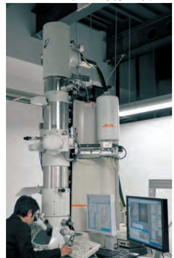
透過電子顕微鏡は高速に加速した電子線を薄い試料を通過させ像として観察する
